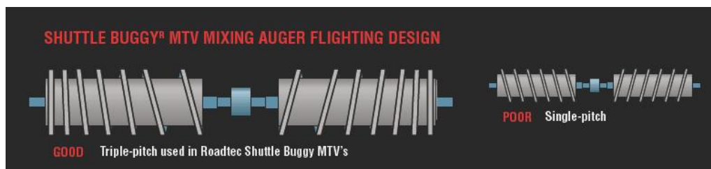
Fig: Sinfines tipo “triple-pitch” del silo de transferencia de material
