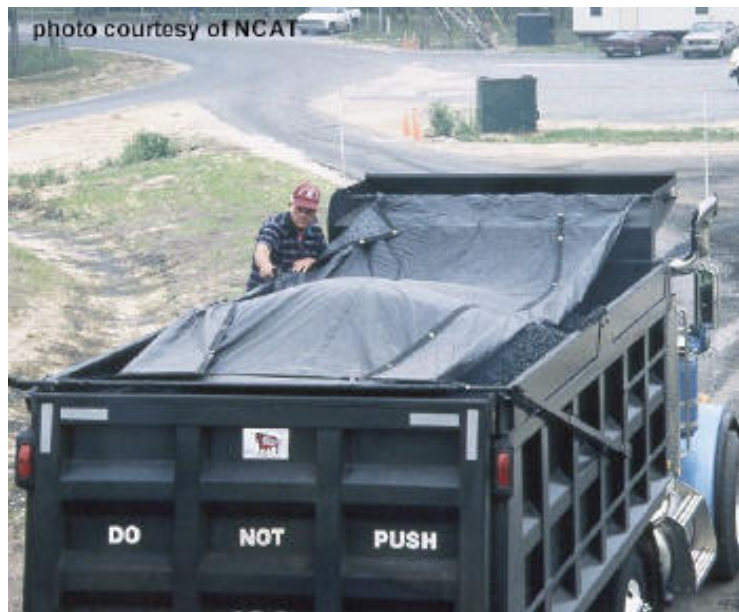
Fig: Conductor cubriendo la caja del camión con una lona
