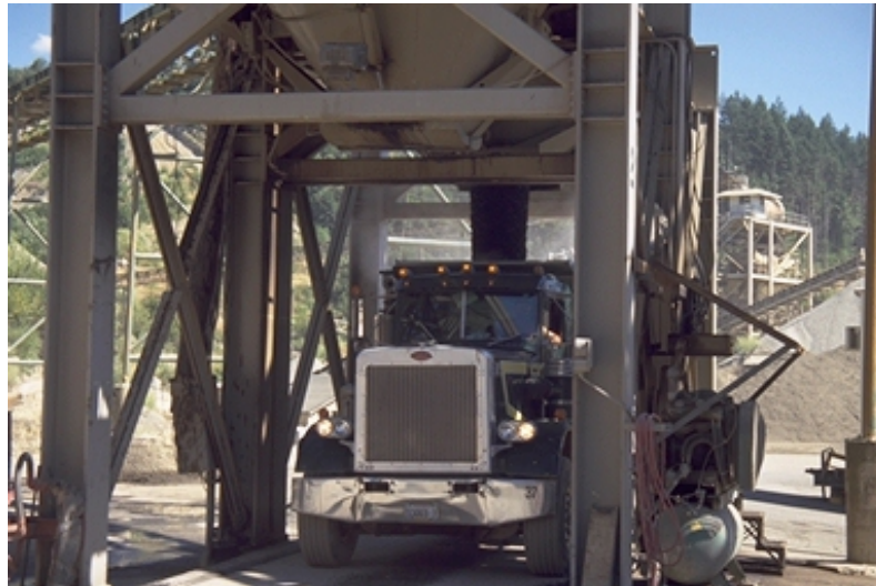
Fig: Vertido de mezcla a camión
