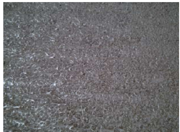
Lechada sin polvo de caucho.
