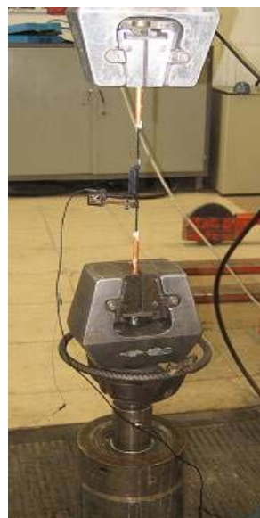
Figura 5.7: Equipo para pruebas de tracción en flejes de refuerzo.
