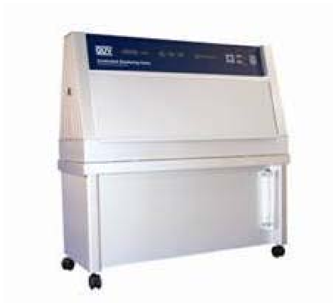
Figura 5.9: Cámara de envejecimiento empleada para ensayos de durabilidad.
