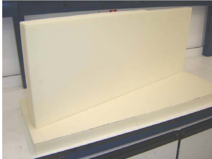
Figura 3.23: Espuma de poliuretano empleada en estructuras tipo sándwich.
