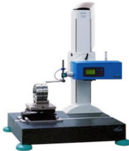
Figura 4.1: Perfilómetro para medida de rugosidad superficial.
