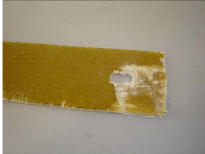
Figura 5.6: Fallo por cortante de las fibras en flejes de refuerzo.
