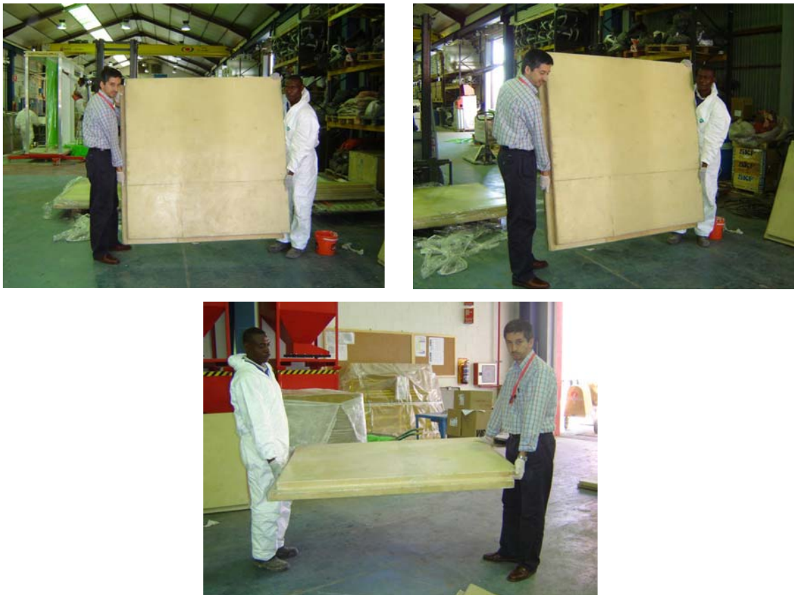
Figura 5.13: Placas de materiales compuestos fabricadas para construcción de prototipo.
