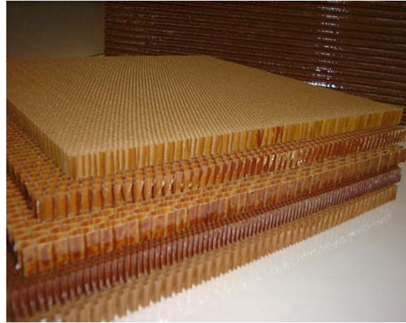
Figura 3.21: Núcleos de nidos de abeja para uso en estructuras tipo sándwich.
