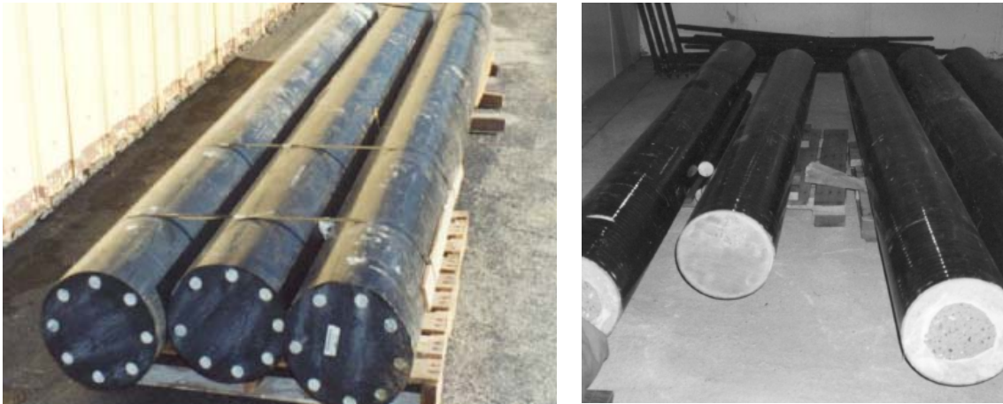
Figura 3.34: Aplicación de FRP's en la fabricación de pilotes.
