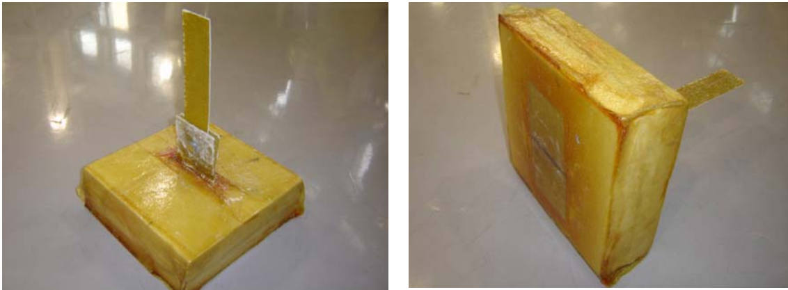
Figura 5.12: Probeta para estudio de sistema de conexión. L atraviesan poliuretano, con posterior refuerzo con dos telas de FV 0/90.
