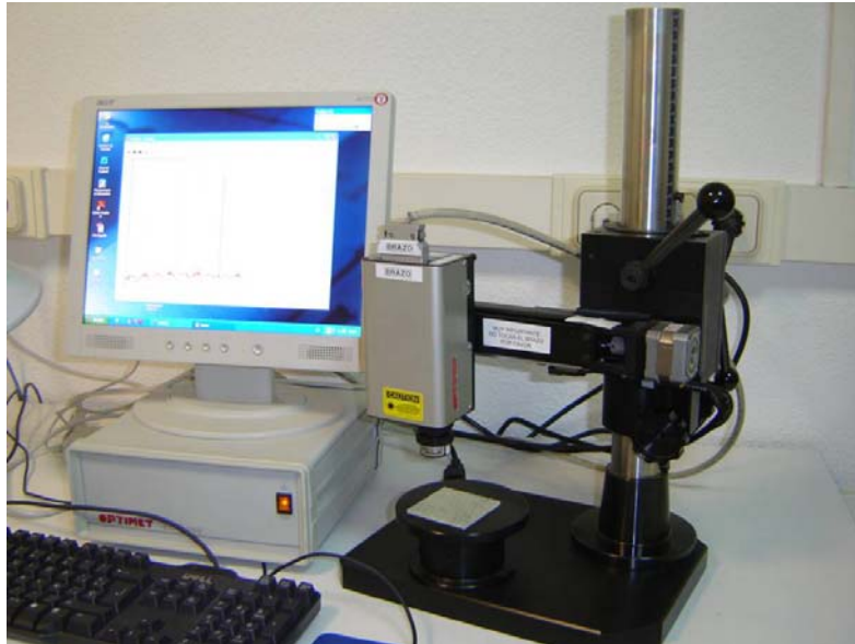
Figura 4.16: Perfilómetro empleado para la determinación de la rugosidad superficial de las placas en materiales compuestos.
