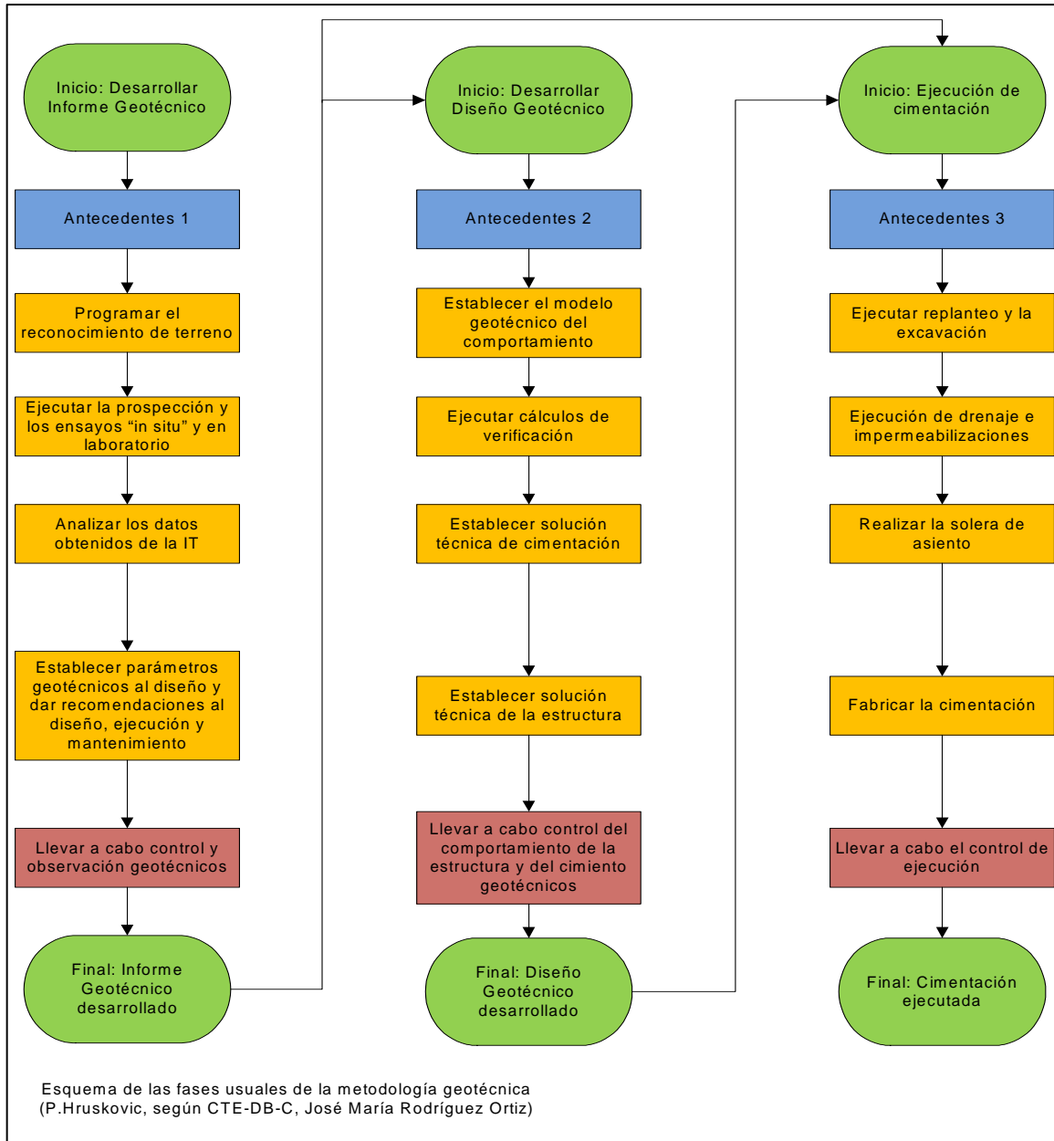
FIGURA 1: Ejemplo de diagrama de flujo de un proyecto geotécnico con las fases de desarrollo pertinentes.
