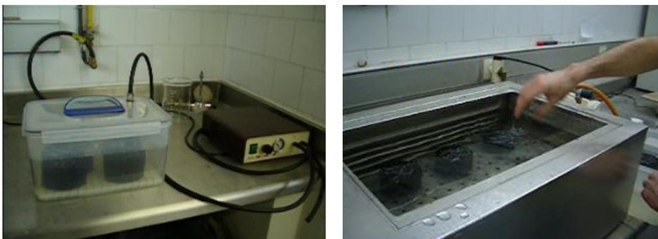
**Figura 3. 15.** a) Probetas sometidas al vacío; b) Probetas a  $40^{\circ}\text{C}$  durante 72h.
