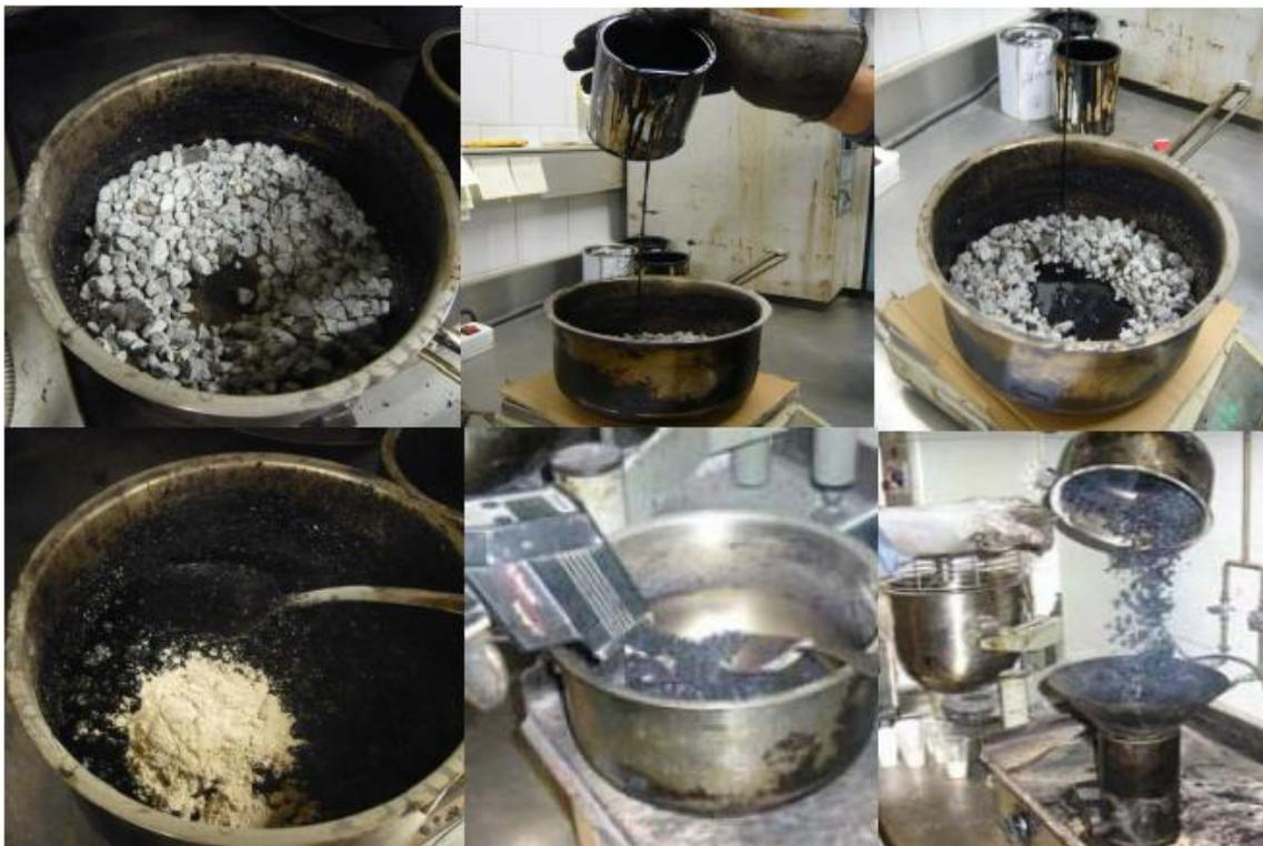
**Figura 3. 6.** Proceso de fabricación. a) Áridos mezclados en un recipiente metálico sobre la plancha, b) Pesamos el betún, c) Mezcla de los áridos con el betún, d) Añadimos el Filler, e) Comprobación de la T°, f) Colocación de la mezcla en el molde
