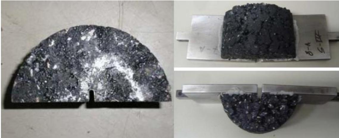
**Figura 3. 18.** a) Media probeta para el ensayo Fénix, b) Probeta fijada a las placas de apoyo.
