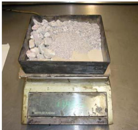
**Figura 3. 3.** Procedimiento de pesado para la preparación de las probetas.
