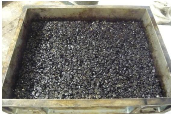
**Figura 3. 23.** Placa después de compactación.
