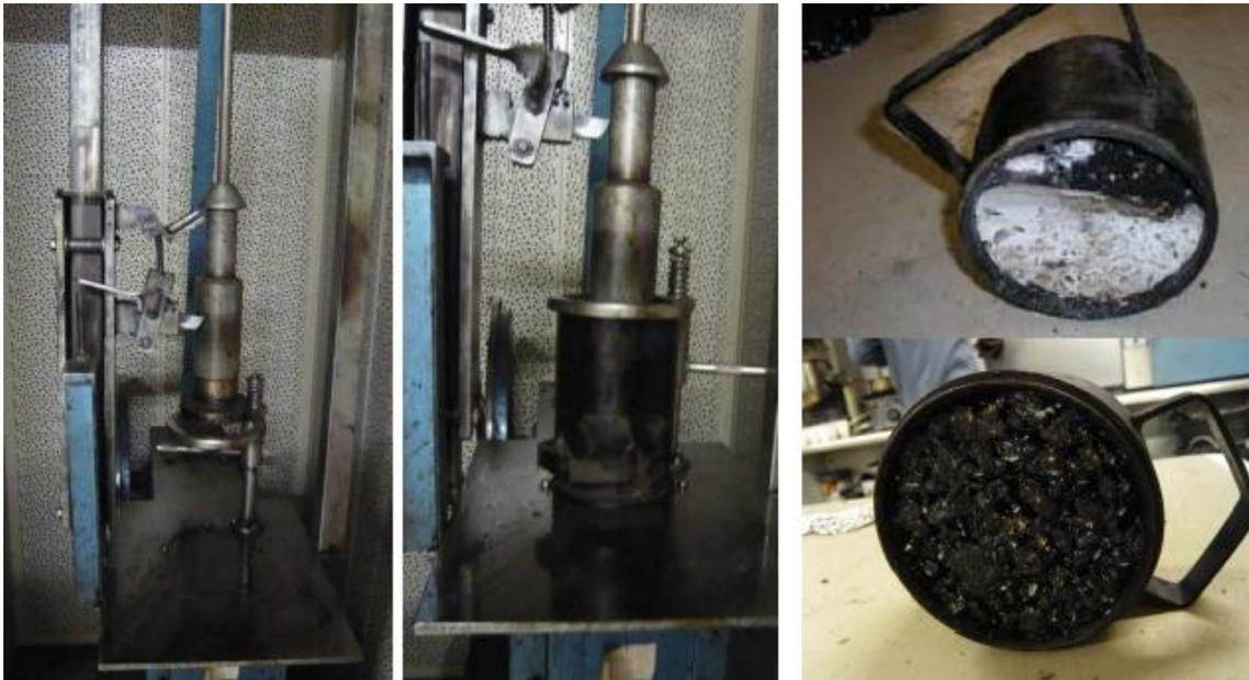
**Figura 3. 7.** a) Máquina de compactación por impacto, b) Probeta en la máquina de compactación, c) Probeta con el papel protector, d) Probeta fabricada antes de desmoldar
