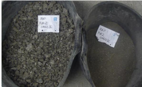
**Figura 3. 4.** Material reciclado RAP clasificado en dos tamaños, “retenido por el tamiz 2 mm” (fracciones 12,5, 8, 4, 2) y “pasa por el tamiz 2 mm” (fracciones 0,5 y 0,063).
