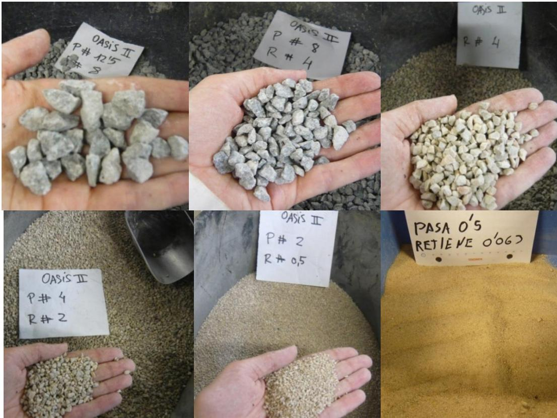
**Figura 3. 2.** Fracciones del árido del proyecto OASIS II.
