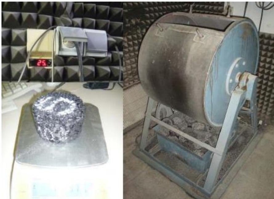
**Figura 3. 11.** a) Temperatura del ensayo Cántabro. b) Pesada de la probeta antes del ensayo c) Máquina de los Ángeles.
