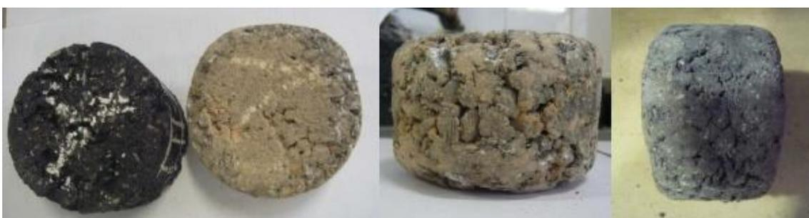
Figura 4. 7. Probeta sometida Ensayo Cántabro.
