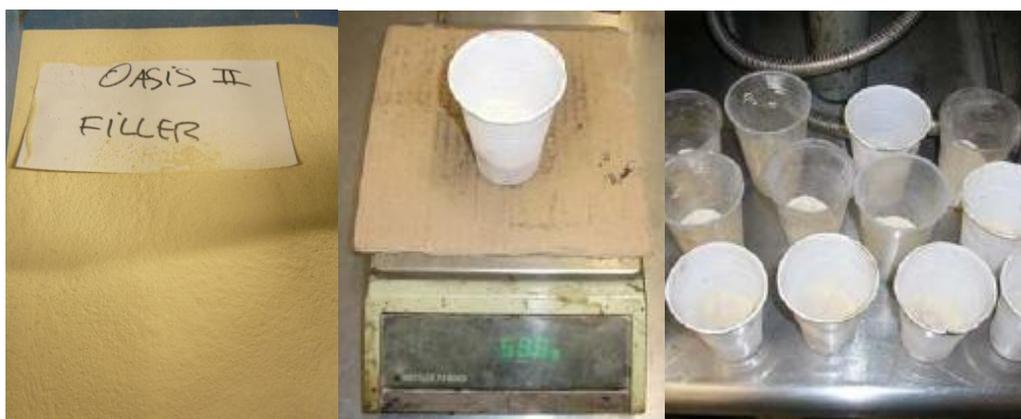
**Figura 3. 5.** Filler pesado en balanza y depositado en vasos de plástico.
