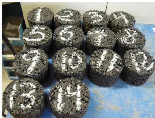
**Figura 3. 8.** Probetas desmoldadas pertenecientes a una serie determinada.
