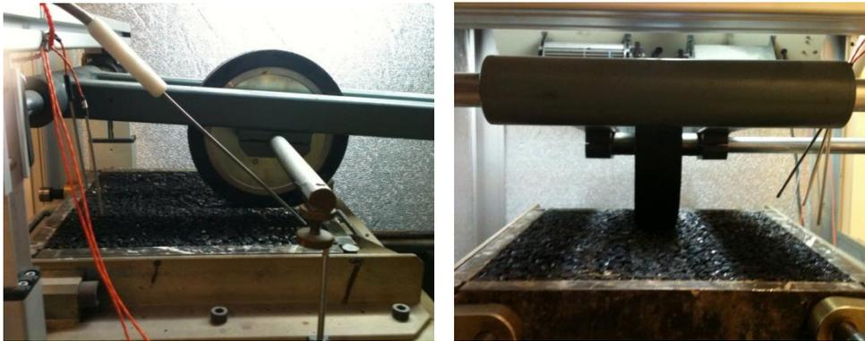
**Figura 3. 24.** a) Máquina de Pista; b) Placa sometida al paso de una rueda con una presión de  $6 \text{ Kg/cm}^2$
