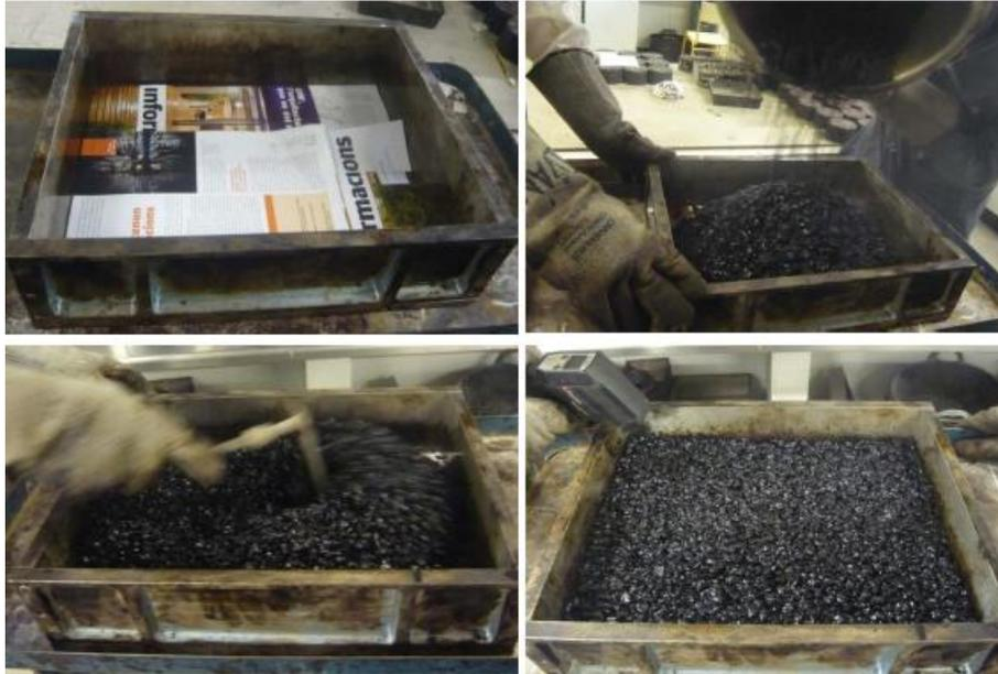
**Figura 3. 21.** . Extendido de la mezcla bituminosa en el recipiente metálico.
