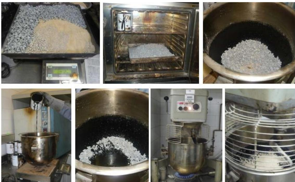
**Figura 3. 20.** Procedimiento de mezclado de mezclas bituminosas para placas.
