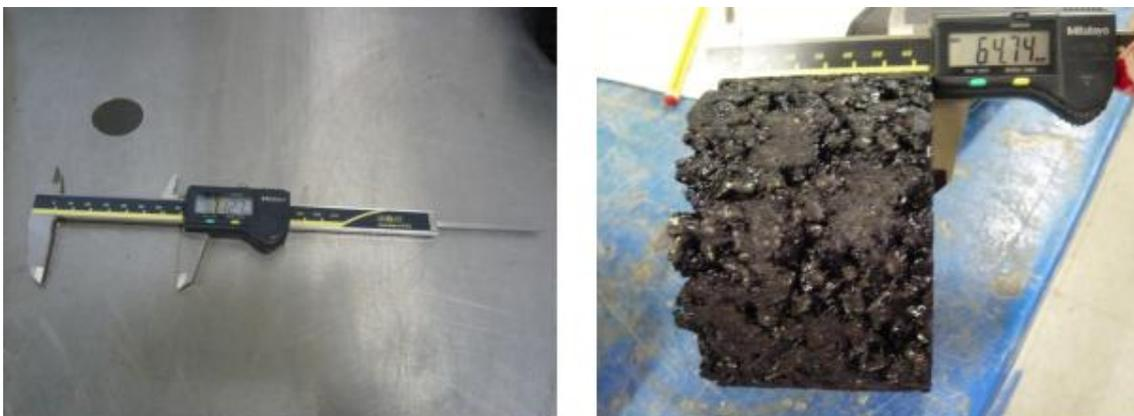
**Figura 3. 9.** a) Pie de Rey b) Medición de la altura de la probeta mediante pie de rey.
