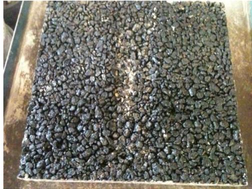
**Figura 3. 25.** Fallo producido por el ensayo de Pista.
