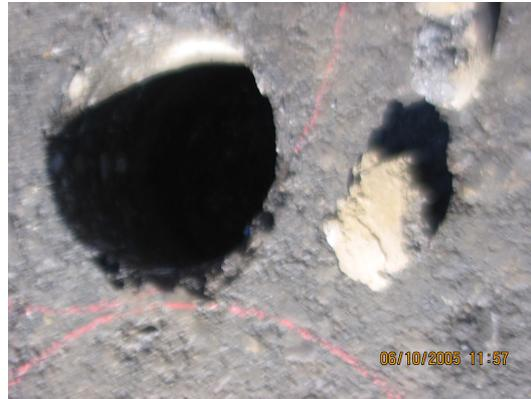
**Figura 2. Perforación de testigo a las 22 horas**
