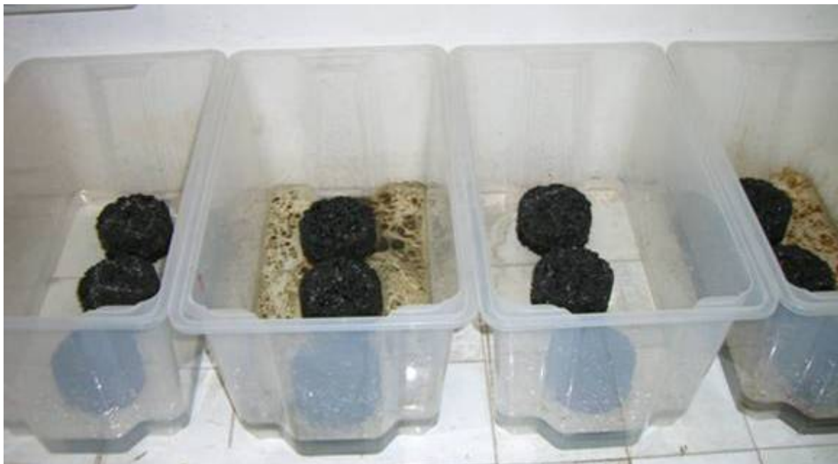
Figura III-31. Ensayo simultáneo de varias series de probetas de mezcla bituminosa porosa mediante la metodología de semi-inmersión en agua con hidrocarburos.
