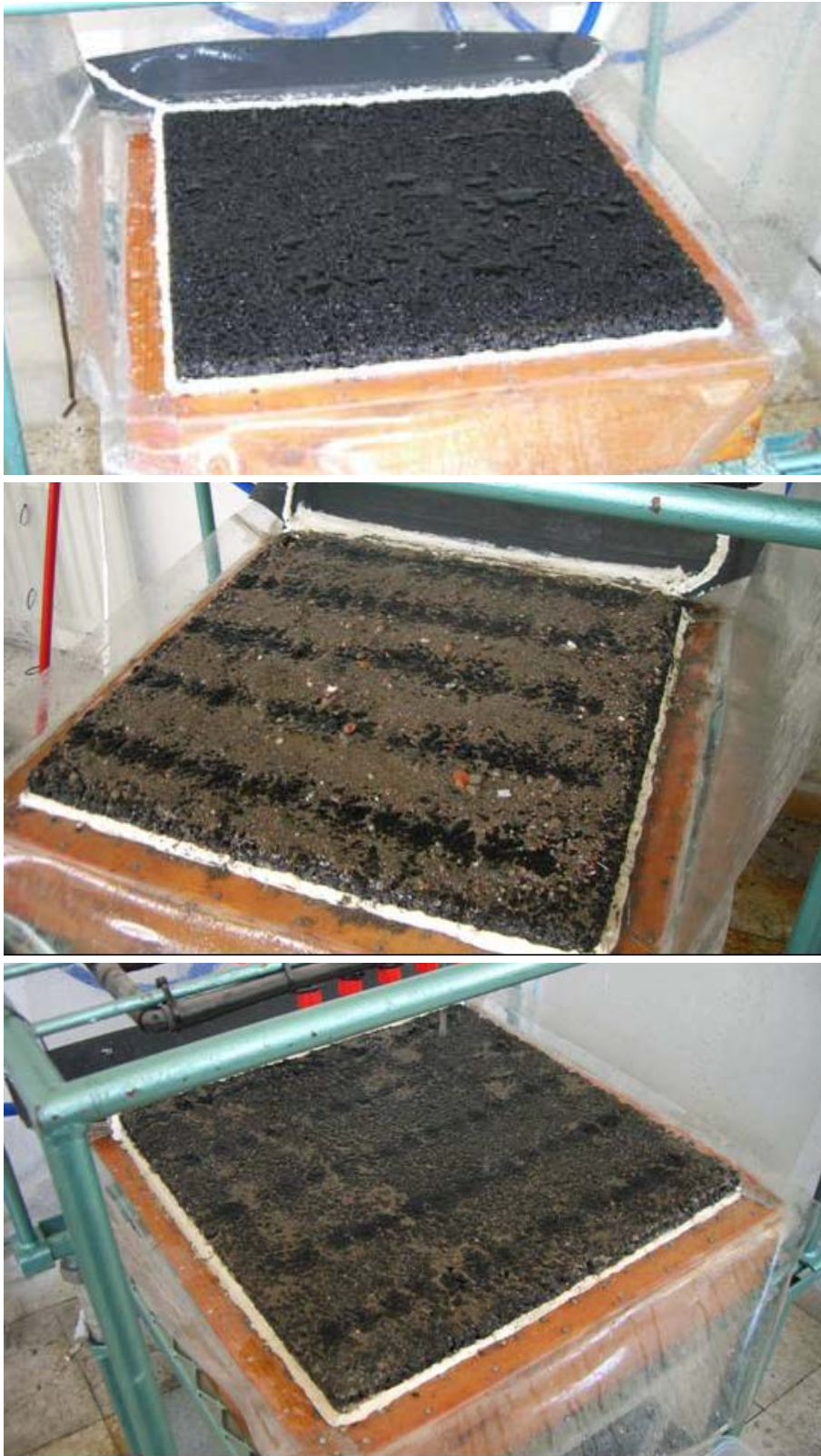
Figura III-13. Pavimento de mezcla bituminosa porosa bajo los tres escenarios de colmatación simulados: recién colocado, colmatado y colmatado con mantenimiento.
