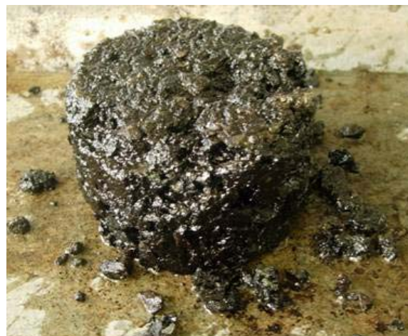
Figura III-27. Ensayo de inmersión completa de probetas de mezcla bituminosa porosa en agua con hidrocarburos.
