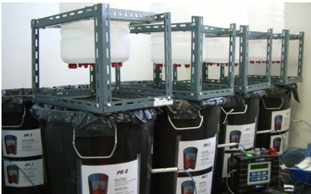
Figura III-45. Simuladores de lluvia empleados con los modelos de firmes permeables del Laboratorio FIDICA.
