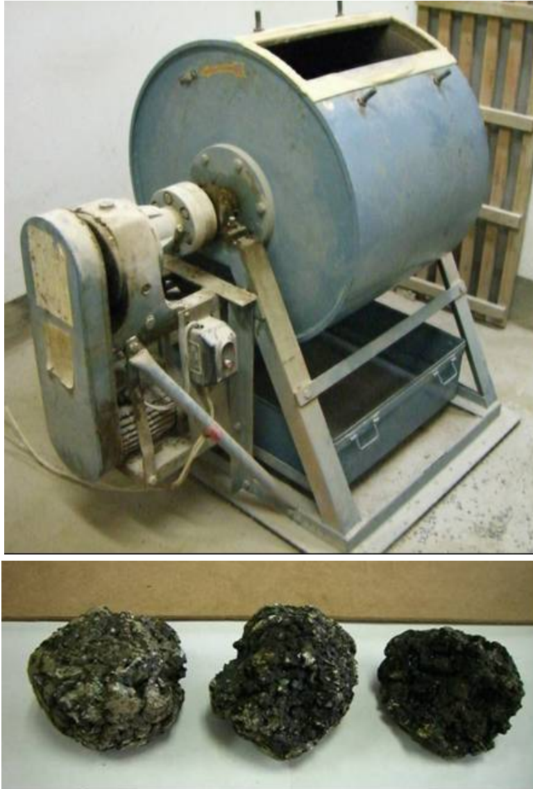
Figura III-23. Máquina de los Ángeles empleada en el ensayo cántabro y distintos desgastes resultantes en probetas Marshall de mezcla bituminosa porosa.
