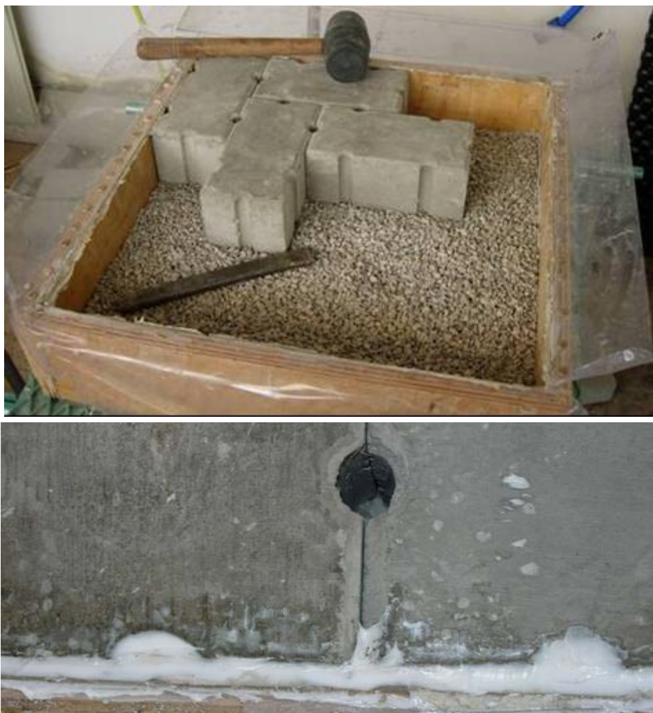
Figura III-5. Construcción de la muestra de pavimento permeable para ensayar en el ICF: colocación de los adoquines y sellado perimetral.
