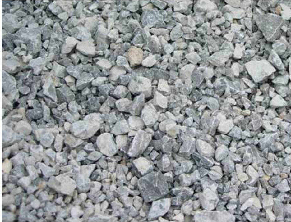
Zahorra drenante de árido calizo procedente de cantera.
