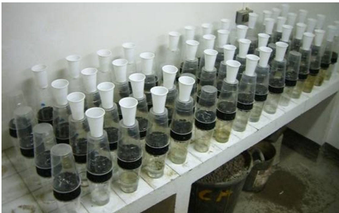
Figura III-29. Ensayo simultáneo de varias series de probetas de mezcla bituminosa porosa mediante la metodología de escurrimiento de agua con hidrocarburos.
