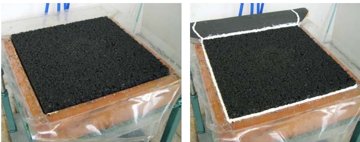
Figura III-9. Construcción de una muestra de pavimento permeable para ensayar en el ICF: colocación de la mezcla bituminosa porosa y sellado perimetral.
