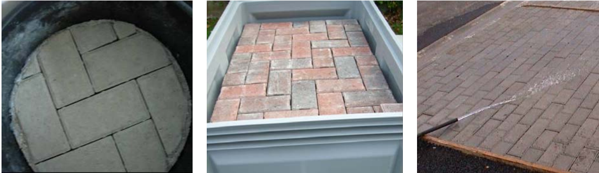
Figura III-32. Adoquines empleados en la construcción de los modelos de firmes permeables del Laboratorio, del Campus y de Gijón.
