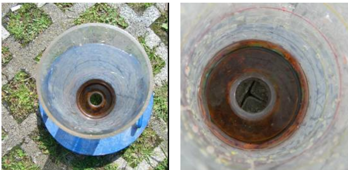
Figura III-18. Situación de los puntos ensayados con el permeámetro LCS en el caso de superficies de césped reforzado y adoquines con ranuras.
