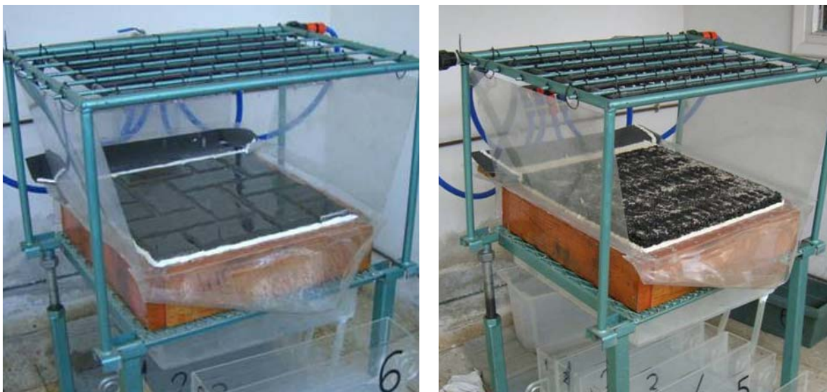
Figura III-14. Ensayos de pavimentos permeables de adoquines con ranuras y de mezcla bituminosa porosa en el ICF.
