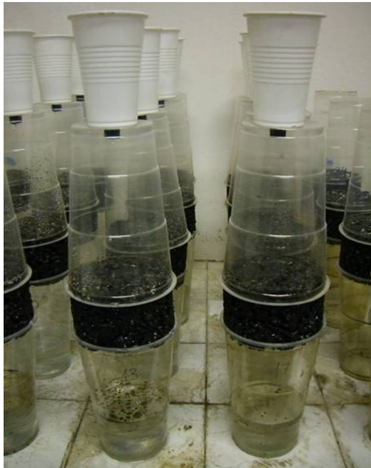
Figura III-28. Ensayo de escurrimiento de agua con hidrocarburos a través de probetas de mezcla bituminosa porosa.
