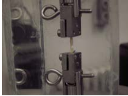
Figura 3.10: Instante de rotura de la arteria.
