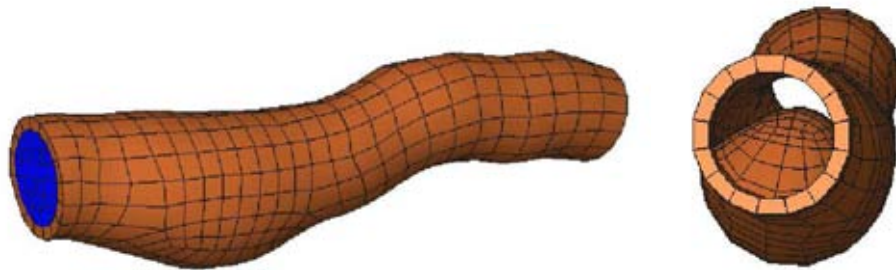
Figura 6.15: Interacción en la LAD dañada. Malla del fluido (en azul) y del sólido (en marrón).
