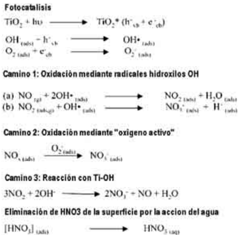
Figura 4: Posibles mecanismos de degradación fotocatalítica de \text{NO}_x . Dalton y col.[0]
