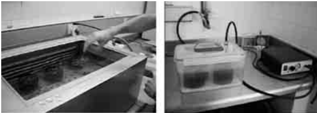
Figura 2. Probetas en saturación al vacío y probetas en baño de agua
