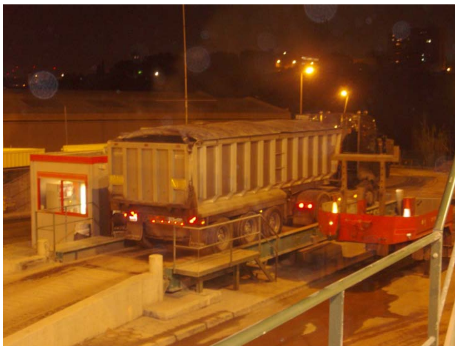
Fig. 3.12 Pesado de camión y protección con lona para proteger la mezcla.
