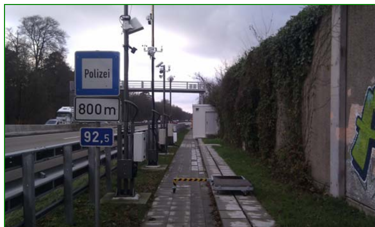
Figura nº9: Campo de pruebas del BAST en la autovía A4. Pueden verse las 4 estaciones meteorológicas que están probándose en estos momentos
