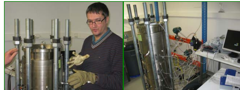
Fig. 2.- Ensayo de erosión e hinchamiento en célula de acero y desmantelamiento del ensayo
