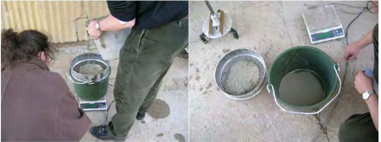
Figura 8.4 Ensayo de resistencia a la segregación en tamiz
