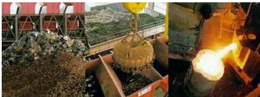
Fig.20 Fundición a partir de material reciclado
