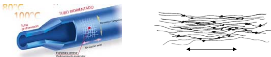
Fig. 109 Orientación molecular tubos PVC-O
