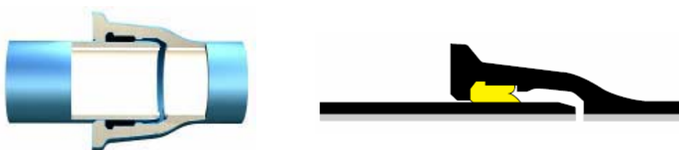
Fig. 25 Junta automática flexible tipo tipoStandard.
