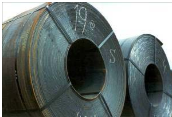
Fig. 57 Acero para tuberías. Bobina laminada en caliente
