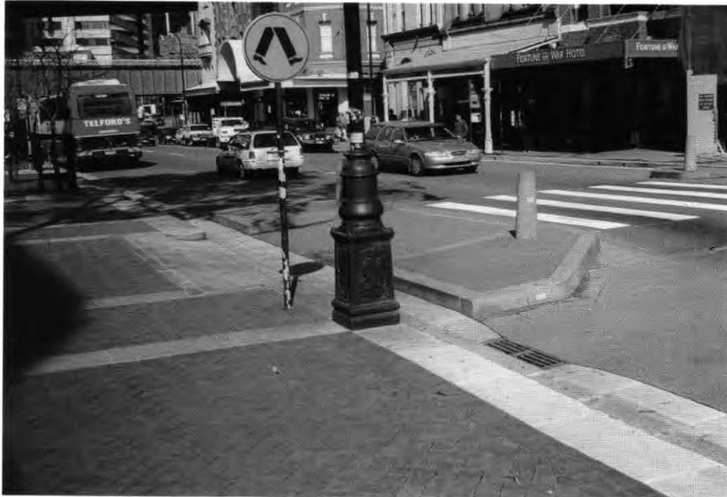
Foto 3: En el caso de que el vado se encuentre previamente bien ejecutado, se pueden instalar elementos fijos que invadan la franja de estacionamiento e impidan que los vehículos aparcuen en el paso peatonal
