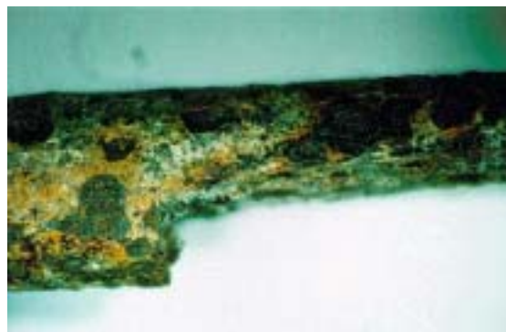
Figura A.14 CBT en un cable pretensado
