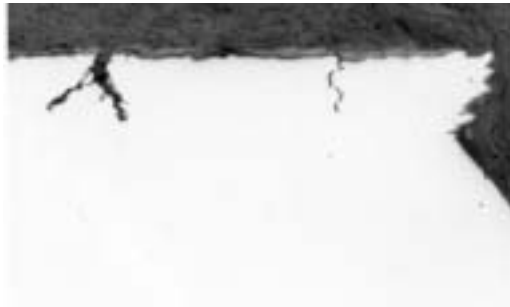
Figura A.11 Microfisuras generadas en la superficie metálica
