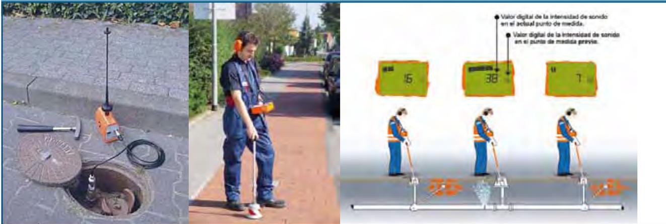
La detección de fugas debe realizarse preferentemente en la noche debido a que durante el día, principalmente en las áreas urbanas, los ruidos ambientales interfieren y se mezclan con el de las fugas dificultando su localización.
