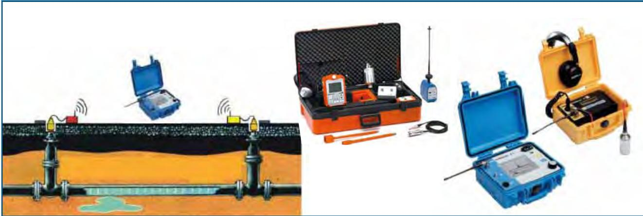
2) Equipos de detección indirecta.- Estos equipos no necesitan contacto con ningún elemento de la red para funcionar. Normalmente detectan el sonido que viaja por el suelo donde se encuentra enterrada
