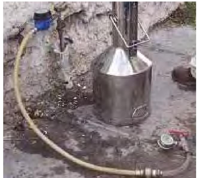
El recipiente está disponible en el mercado y está fabricado en acero inoxidable, tiene un volumen de 20 litros aproximadamente y cuenta con una escala graduada al decilitro, colocada cerca de un tubo transparente para visualizar el nivel del agua. En el esquema de la figura 1.6 se muestran las dimensiones del recipiente de prueba.
