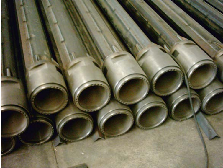
Varillaje para perforación con circulación inversa. (Imagen cortesía de Sondeos Puebla, S.L.)
