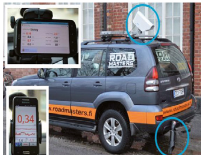
Ilustración 8 – Objeto de estudio: medidor óptico de fricción vaisala dsp 310 (arriba) y medidor óptico de fricción teconer rcm411 (abajo). Los celulares actúan como pantalla e interfaz de usuario en ambos dispositivos.
