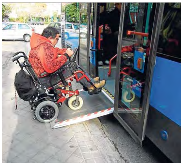
Gráfico 31.- Ejemplo de autobús urbano de suelo bajo con rampa automática de acceso.
