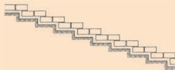
Fig. 99. Escaleras sobre lecho de arena a capas rodantes de adoquín cerámico en suelos recrecidos escalonados.
