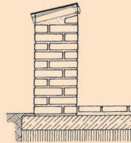
Fig. 83. Cubrición con gran saliente.
