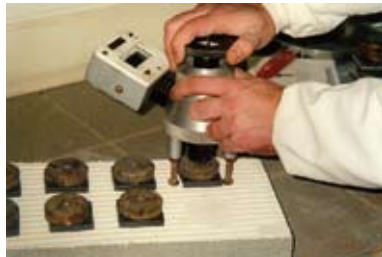
Arranque de la plaqueta tras realizar un esfuerzo a tracción (ANFAPA)
