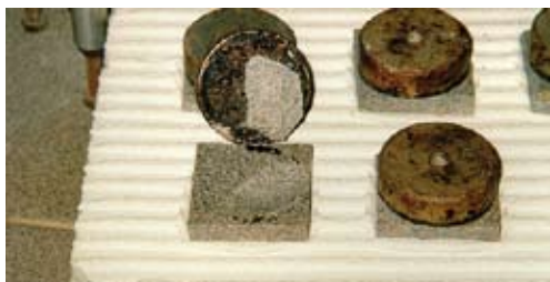
Rotura cohesiva en la baldosa (ANFAPA) RC-B
