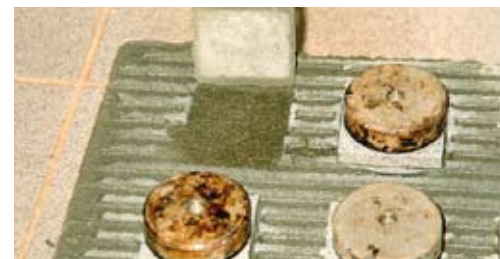
Rotura adhesiva adhesivo/soporte (ANFAPA) RA-S
