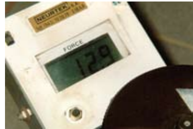
Valor de la medición de la adherencia (ANFAPA)
