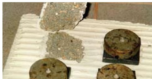
Rotura cohesiva en el soporte (ANFAPA) RC-S
