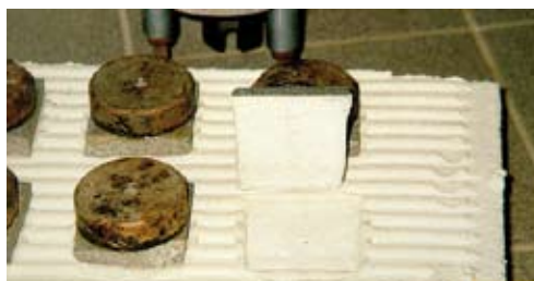
Rotura cohesiva en el adhesivo (ANFAPA) RC-A
