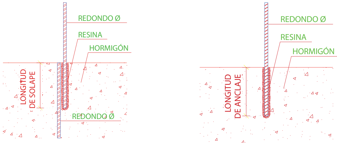
Figura 1.- Solape y anclaje de barras verticales.
