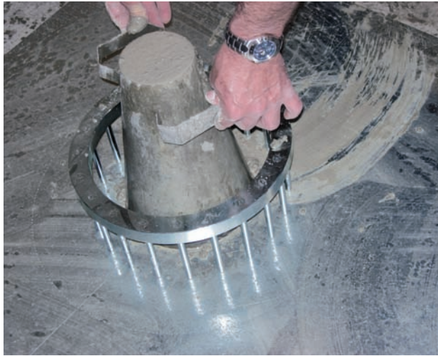
Figura 8.- Ensayo del anillo japonés.
