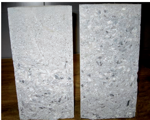
Figura 11.- Ensayo de rotura indirecta por tracción (Brasileño) sobre probeta de hormigón autocompactante.
