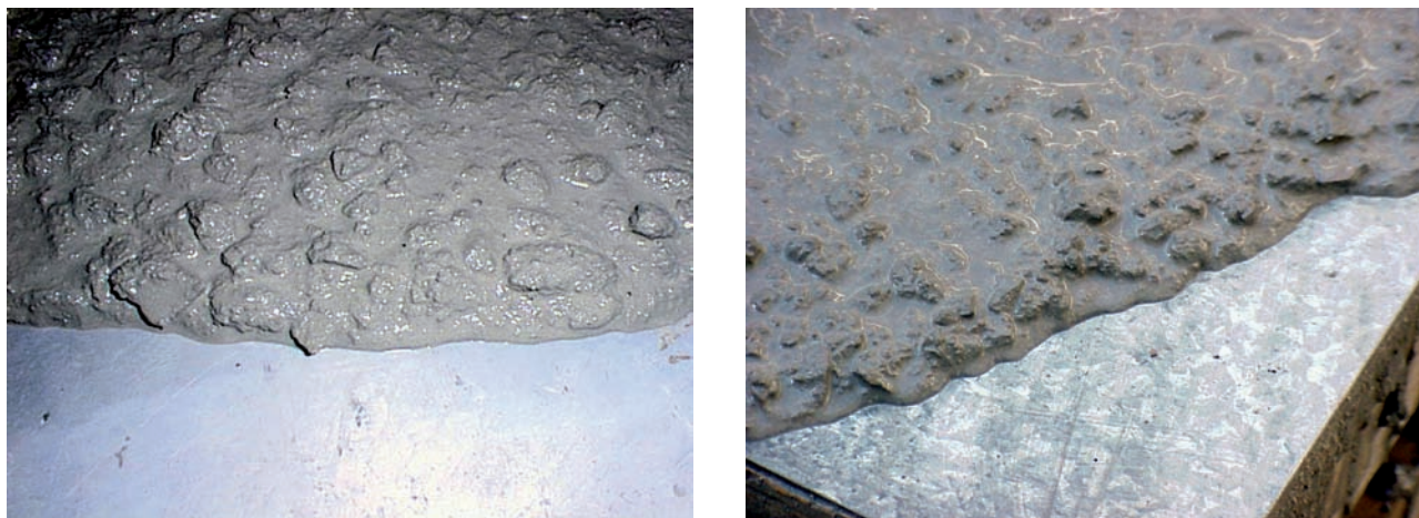
Figura 10.- Ensayo de índice visual de estabilidad (valor índice = 1'5).
