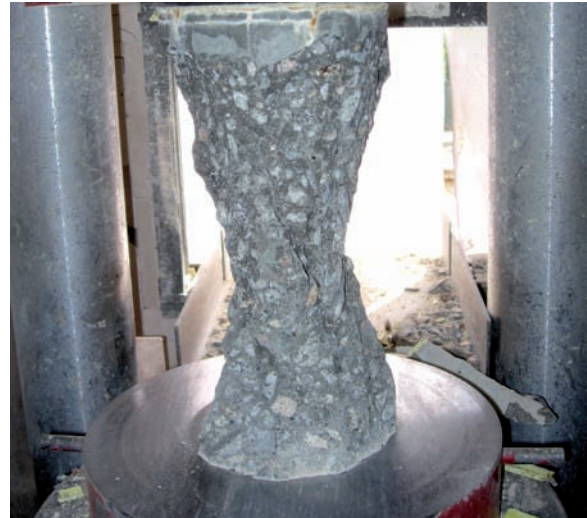
Figura 12.- Ensayo de rotura a compresión sobre probeta de hormigón autocompactante.
