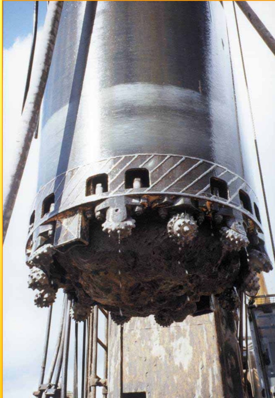
Corona tipo Bauer, para cortar y penetrar en el basalto (Gentileza de Terratest)
