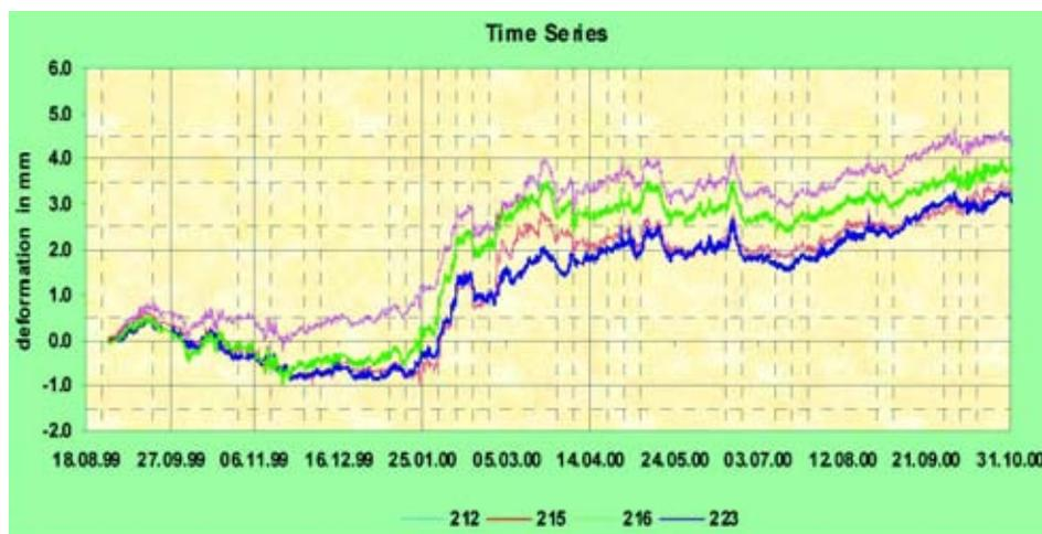
Figura 3.5. GRÁFICO TIEMPO/MOVIMIENTOS DE VARIOS PUNTOS DE CONTROL.
