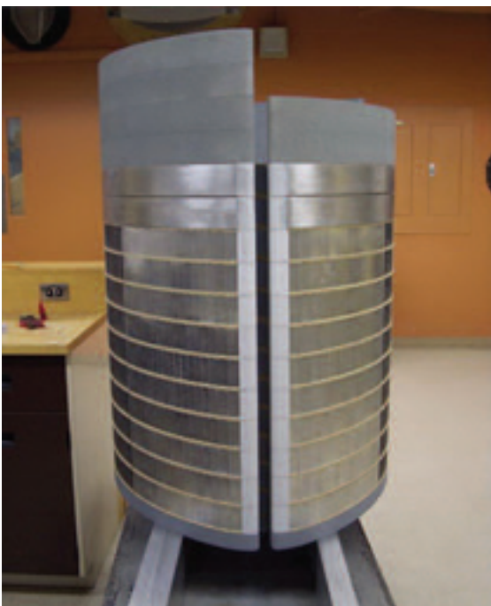
Figura 13. Vista del modelo parcial desarrollado para estudiar el efecto de la doble fachada en el comportamiento frente a viento.
