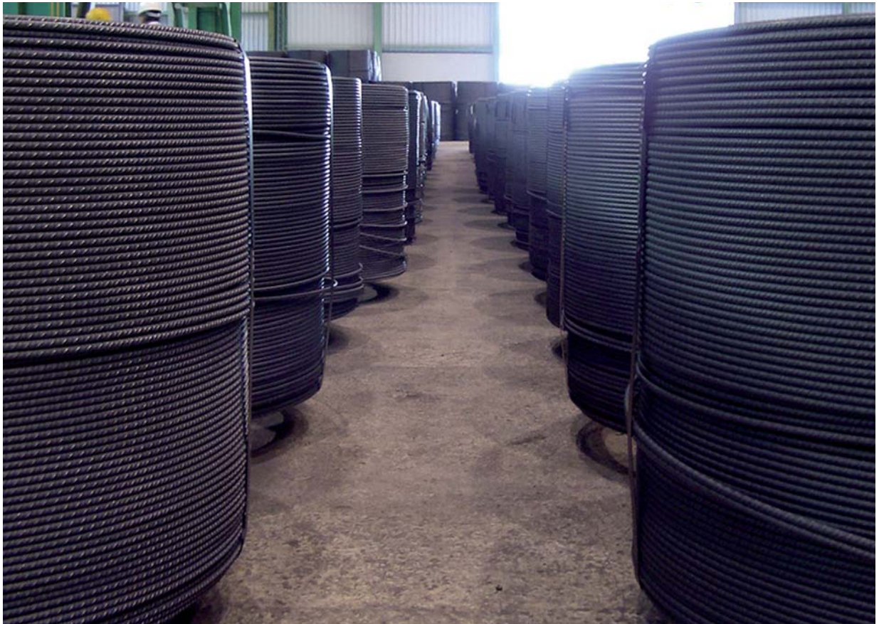
⇒ Figura 2.- Acero para armaduras pasivas suministrado en rollo.
