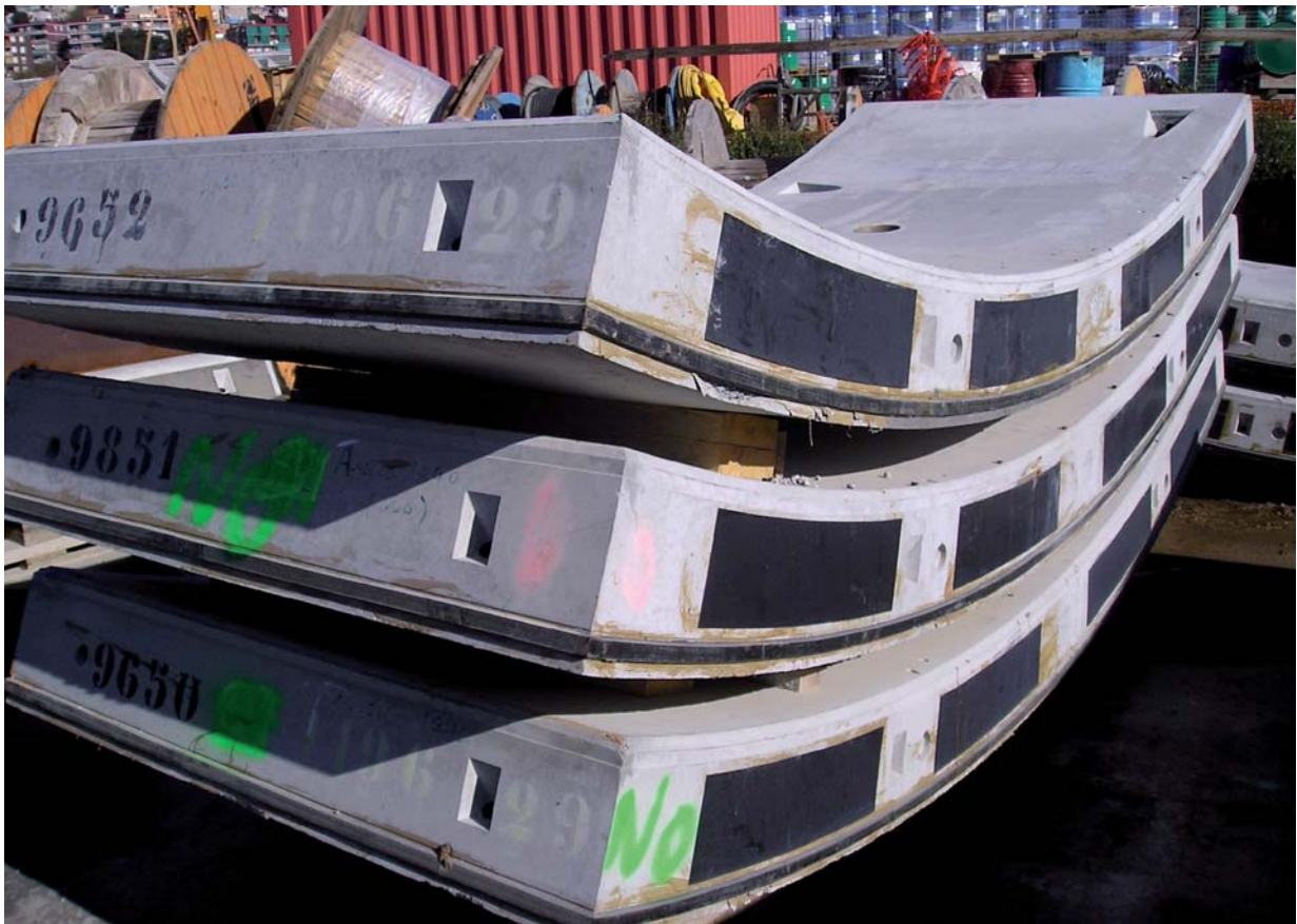
⇒ Figura 4.- Dovelas de hormigón de alta resistencia con fibras para revestimiento de túneles.
