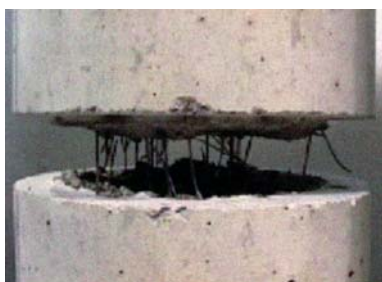
Figura 1.- Probeta de hormigón con fibras sometida a ensayo de tracción directa.
