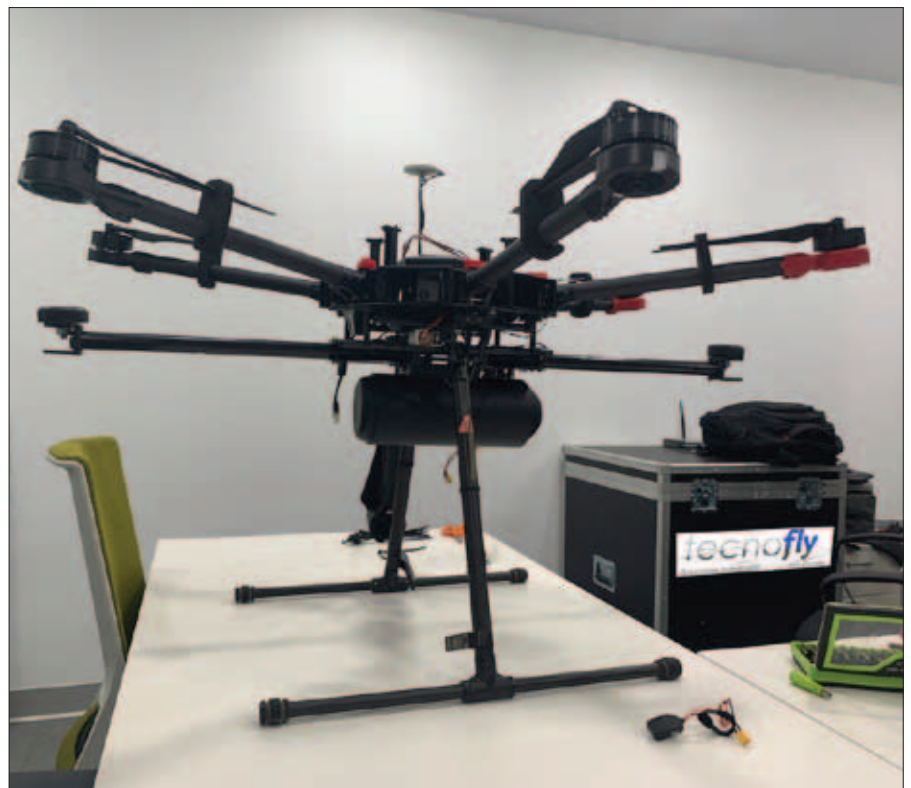
Dron multirrotor con equipo LIDAR embarcado.
