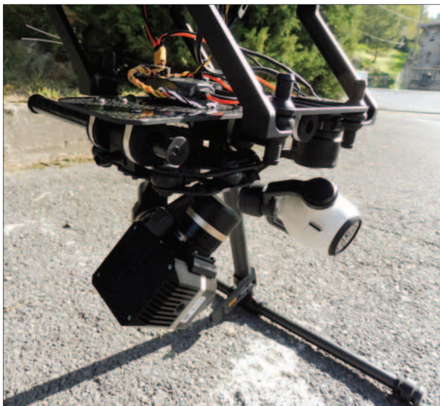
Cámara termográfica (i) y cámara RGB (d) embarcadas en dron.
