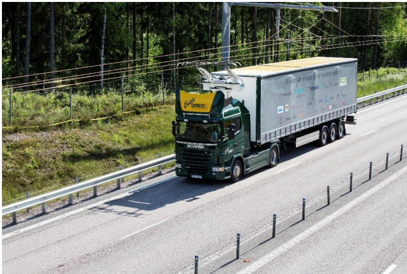
Ilustración 2.7 - Carretera eléctrica cerca de Gävle, Suecia - Camiones eléctricos
